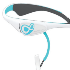
圖 1 Neurosky BrainLink Lite BL001 腦波測量儀器
